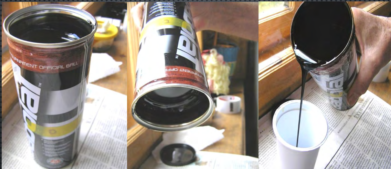
Фиг. 2. Текучесть сырья (в жестяной таре) при температуре T=+20\text{ }^{\circ}\text{C} , 1,2 - до обработки, 3 – после обработки
