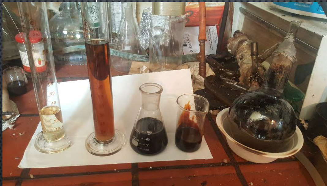
Фиг. 1. Фракционный состав пробы 300 мл после коксования. Слева направо: к.к.-250°С, к.к.-300°С, к.к.-350°С, к.к.-380°С, кокс
