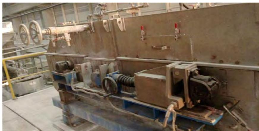
Основная задача двухсетчатого пресса – отделить целлюлозу от примесей, мусора и повысить непрерывность производства. Обезвоженные волокна нуждаются в промывке под струей высокого давления и увлажняющем орошении.
